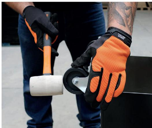
C- À l'aide d'un maillet, frapper doucement pour enfoncer la roue jusqu'au blocage.
