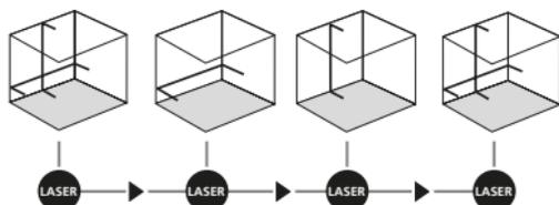
! Voor de horizontale en verticale nivellering moet de transportbeveiliging gedeactiveerd zijn. De LED (2) brandt constant groen. Zodra het apparaat zich buiten het automatische nivelleerbereik van 5° bevindt, knipperen de laserlijnen en brandt de LED (2) rood. Positioneer het apparaat zodanig dat het zich binnen het nivelleer-bereik bevindt. De LED (2) schakelt weer over naar groen en de laserlijnen branden constant.
