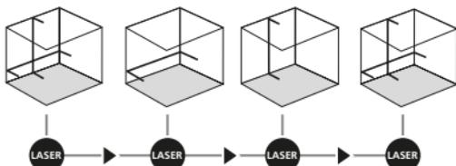
A vízszintes és a függőleges szintezéshez ki kell oldani a szállítási biztosítót. A LED (2) folyamatosan zöld fényel világít. Amint a készülék az automatikus 5°-os szintezési tartományon kívül van, villognak a lézervonalak, és a LED (2) pirosan világítani kezd. Állítsa be a készüléket úgy, hogy az a szintezési tartományon belül legyen. A LED (2) ismét zöldre vált, és a lézervonalak folyamatosan világítanak.
