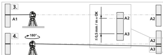
Quand A2 et A3 sont distants de plus de 0,5 mm / m l'un de l'autre, un réglage de l'appareil est nécessaire. Prenez contact avec votre revendeur ou appelez le service après-vente de UMAREX-LASERLINER.
