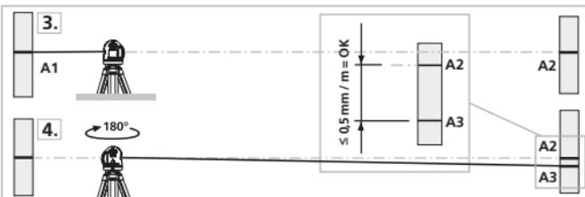
! Jos A2 ja A3 ovat toisistaan etäämmällä kuin 0,5 mm / m, on säätö tarpeen. Ota yhteys paikalliseen laitetoimittajaan tai UMAREX-LASERLINER huolto-osastoon.
