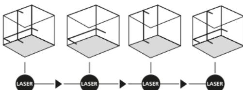
Для горизонтального и вертикального нивелирования необходимо снять с блокировки фиксатор для транспортировки. Постоянно горит зеленый светодиод (2). Как только прибор окажется за пределами автоматического диапазона нивелирования, равного 5°, лазерные линии и светодиод (2) начинают гореть красным цветом. Позиционировать прибор так, чтобы он находился в пределах диапазона нивелирования. Светодиод (2) снова изменяет свой цвет на зеленый, а лазерные линии светятся постоянно.
