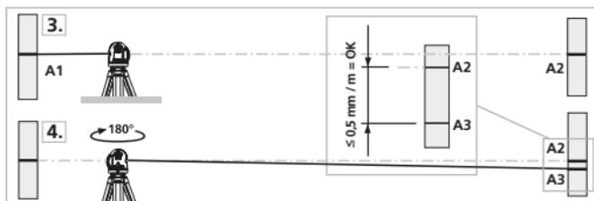
! Om A2 och A3 ligger mer än 0,5 mm / m från varandra behöver enheten justeras. Kontakta er återförsäljare eller vänd er till serviceavdelningen på UMAREX-LASERLINER.
