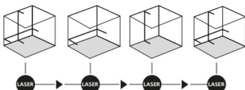
! Til horisontal og vertikal nivellering skal transportsikringen være løsnet. LED (2) lyser konstant grøn. Så snart apparatet er uden for det automatiske nivelleringssområde på 5°, blinker laserlinjerne, og lysdioden (2) løser rødt. Apparatet skal positioneres således, at det er inden for nivelleringsområdet. Lysdioden (2) skifter igen til grøn, og laserlinjerne lyser konstant.
