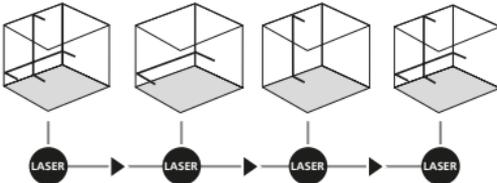
! Yatay ve düşey düzleştirme için taşıma emniyetinin çözülmüş olması gerekmektedir. LED (2) sabit şekilde yeşil yanar. Cihaz otomatik düzleştirme aralığı olan 5°'nin dışında bulunduğu zaman, lazer çizgileri yanıp sönmeye başlarlar ve LED (2) kırmızı yanar. Cihazı düzleştirme aralığı içinde bulunacak şekilde konumlandırınız. LED (2) yine yeşile döner ve lazer çizgileri sabit yanarlar.
