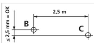
**!** Verifique regularmente a calibragem antes de usar, após transportes e depois de armazenar durante bastante tempo.
