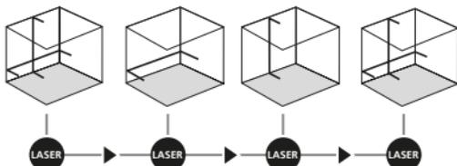
Transportni zatvarač se mora otpustiti za horizontalno i vertikalno niveliranje. LED (2) svijetli zeleno. Laserske linije bljeskaju i upali se crveni LED (2) čim je uređaj izvan raspona automatskog niveliranja od 5°. Postaviti uređaj da bude unutar raspona nivelacije. LED (2) se ponovno prebacila na zeleno, a laserske linije prestanu bljeskati (svijetli postojanim svjetlom).
