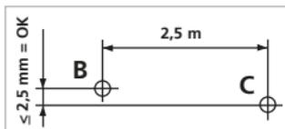
**!** Należy regularnie sprawdzać kalibrację przed użyciem, po zakończeniu transportu i po dłuższym przechowywaniu.
