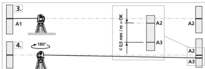
Pokud jsou body A2 a A3 od sebe vzdáleny více než 0,5 mm / m, je nutné provést kalibraci. Spojte se s Vaším specializovaným prodejcem nebo využijte servisního oddělení společnosti UMAREX-LASERLINER.
