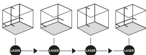
! Per il livellamento orizzontale e verticale si deve allentare la sicura di trasporto. Il LED (2) rimane acceso in verde. Non appena l'apparecchio si venisse a trovare al di fuori del campo di livellamento automatico di 5°, le linee laser iniziano a lampeggiare e si accende la luce rossa del LED (2). Posizionare l'apparecchio in modo che si trovi all'interno del campo di livellamento. La luce del LED (2) diventa verde e le linee laser emettono una luce costante.
