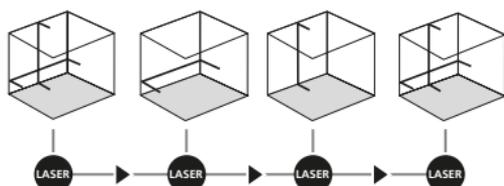
! Vid horisontell och vertikal nivellering måste transportsäkringarna lossas. Lysdioden (2) lyser konstant grön. Så fort enheten befinner sig utanför det automatiska nivelleringsområdet på 5°, blinkar laserlinjerna och lysdioden (2) tänds i röd färg. Positionera enheten på ett sådant sätt, att den befinner sig inom nivelleringsområdet. Lysdioden (2) växlar över till grön igen och laserlinjerna lyser konstant.
