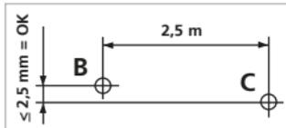
**!** Слід регулярно перевіряти калібрування приладу перед його використанням, після транспортування та тривалого зберігання.
