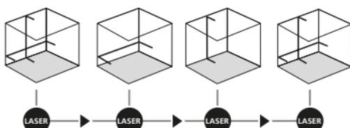
Для горизонтального і вертикального нівелювання необхідно розфіксувати транспортне стопоріння. Постійно світиться зелений світлодіод (2). У разі виходу за межі діапазону автоматичного нівелювання, що становить 5°, лазерні лінії починають блимати, а світлодіодний (2) індикатор загоряється червоним світлом. Розташуйте прилад так, щоб він потрапив у межі діапазону автоматичного нівелювання. Світлодіод (2) знову змінить колір на зелений, а лазерні лінії загоряться сталим світлом.
