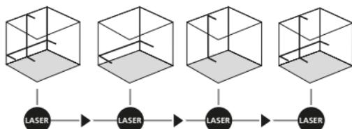
Il est nécessaire de dégager le blocage de transport pour procéder au nivellements horizontal et vertical. La DEL (2) est allumée en permanence en vert. Dès que l'instrument se trouve en dehors de la plage de nivellement automatique de 5°, les lignes laser clignotent et la DEL (2) s'allume en rouge. Positionner l'instrument de manière à ce qu'il soit dans la plage de nivellement. La DEL (2) passe de nouveau au vert et les lignes laser sont allumées en permanence.
